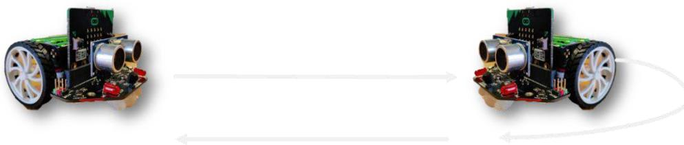
Pritiskom na tipkalo A na upravljačkom micro:bitu kolica se kreću naprijed, a pritiskom na tipkalo B kolica se kreću natrag. Kad pritisnemo oba tipkala istodobno, kolica se zaustave.
