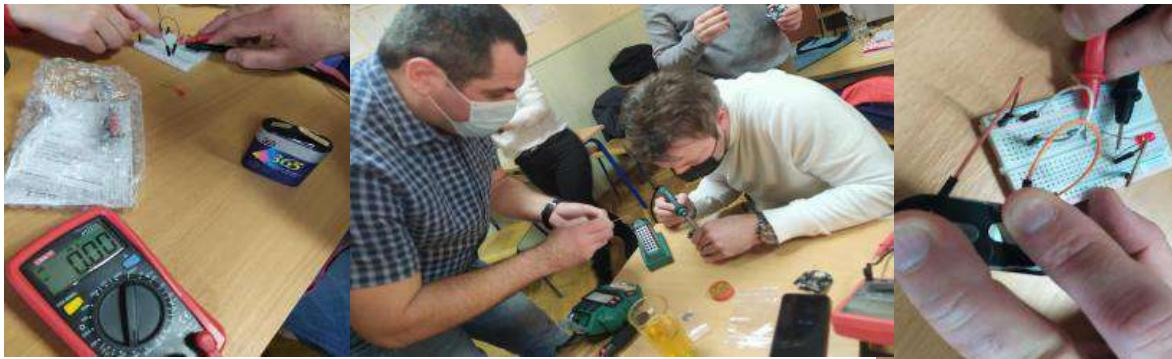
Potreban materijal: elektronički elementi; otpornici, LED, tranzistori, kondenzatori, ispravljačke diode, eksperimentalna pločica, tiskana pločica, vodiči, izvor napajanja (baterija).
